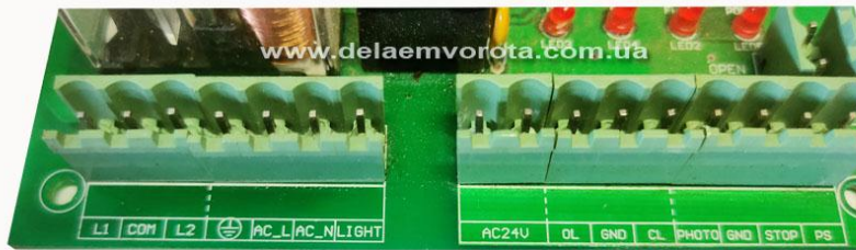
1. клеми «заземлення» немає
